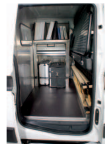
Schrankeinheit mit Bodenfach für Messkoffer, Schublade für Kleinteile, Ablage für Ordner (optional als Zubehör erhältlich) Art. Nr. 103044
